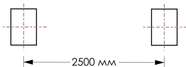
Столбы 63х83 для сплошного забора со всеми типами креплений
