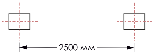
Столбы 63х52 для сплошного забора с Г-креплением для T14, T26
