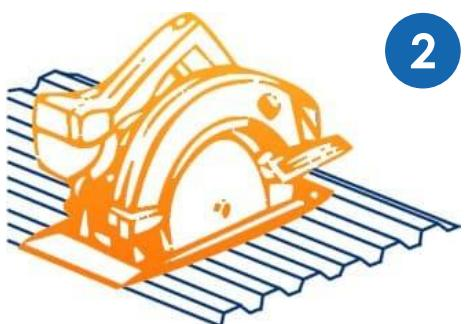
Рекомендуем обязательно прочно зафиксировать листы, чтобы предотвратить движение во время резки. После процедуры резки – удалите поликарбонатную пыль и стружку с обрезанных краёв листа сжатым воздухом или пылесосом, ни в коем случае не снимайте мусор руками!
