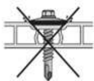
Рисунок 13а НЕВЕРНО! перетянут саморез
