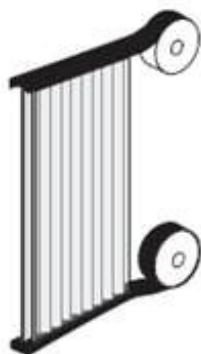
Рисунок 17б. Заклеивание открытых концов панели
