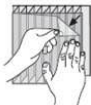
Рисунок 17б. Заклеивание открытых концов панели
