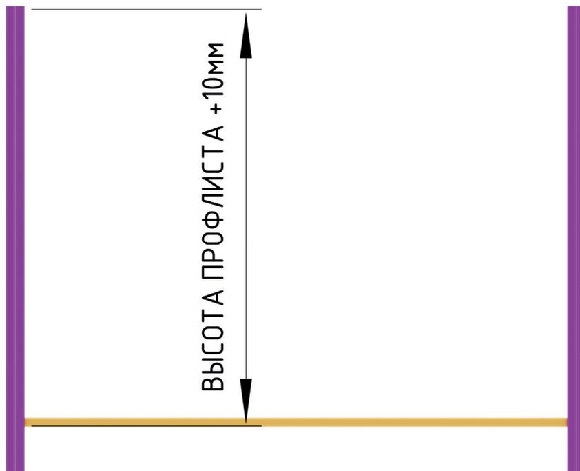
Монтируем нижний прогон как показано на рисунке. Профиль Т-26 размещаем раскрытой стороной кверху.
