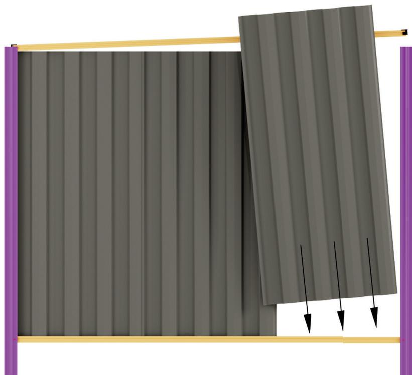
Затем опускаем верхний прогон на свое место и фиксируем его саморезами.
